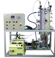
5kW導入事例 ブリッジマン真空炉
