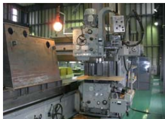
名称 寿 プラミラー 型式 OPM-1111型 仕様 ストローク X 3550 Y 1100 Z 1300 (コラムヘッド) Z 970~100
