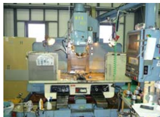
名称 OKK NCフライス盤 型式 MHA-450 仕様 ストローク X 900 Y 450 Z 400
