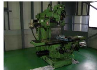
名称 遠州 立フライス盤(治具中ぐり盤) 型式 TJ3 仕様 ストローク X 850 Y 500 Z 400
