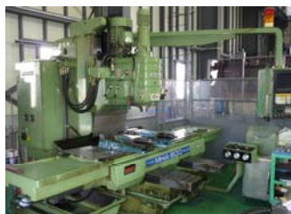
名称 OKK NCフライス盤 型式 MHA-600 仕様 ストローク X 1500 Y 600 Z 600
