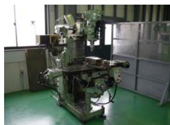
名称 牧野 立フライス盤 型式 2KGA 仕様 ストローク X 600 Y 300 Z 300
