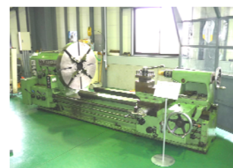
名称 津田 12尺旋盤(正面盤) 型式 TFL-1200X1000 仕様 振り(ヘッド)上 φ900 (往復台上 φ600) 芯間長さ 180
