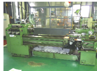
名称 池貝 8尺旋盤 型式 A25 仕様 振り(ヘッド)上 φ500 (往復台上 φ250) 芯間長さ 1500
