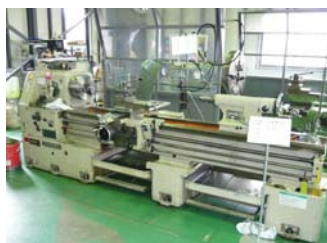
名称 滝沢 10尺旋盤 型式 TAL-580 仕様 振り(ヘッド)上 φ600 (往復台上 φ350) 芯間長さ 1800
